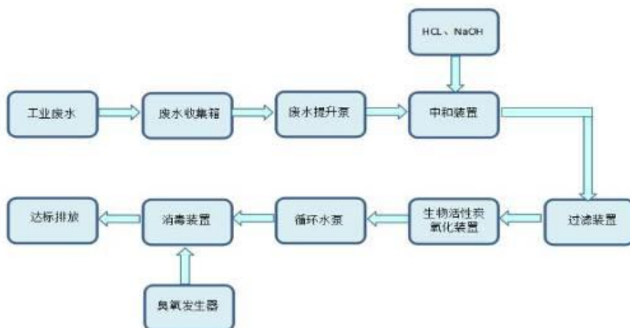
图8-1废水处理工艺流程图
